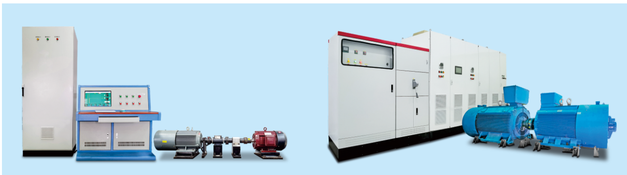
永磁&amp;异步电机扭矩对拖测试台
